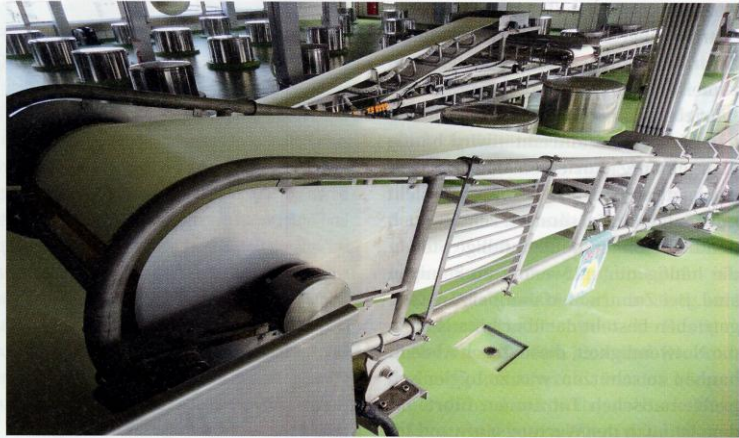
Beim Wrap-Förderer wird für den Schüttguttransport der Gurt zum Förderschlauch geformt
