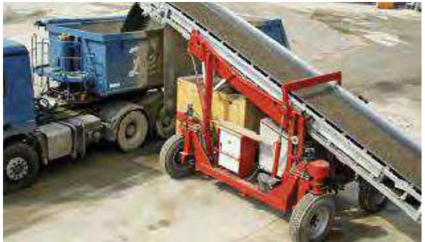
Dank der um 90° verstellbaren Räder kann der Förderbandwagen parallel zur Längsseite des Zuges verfahren werden
