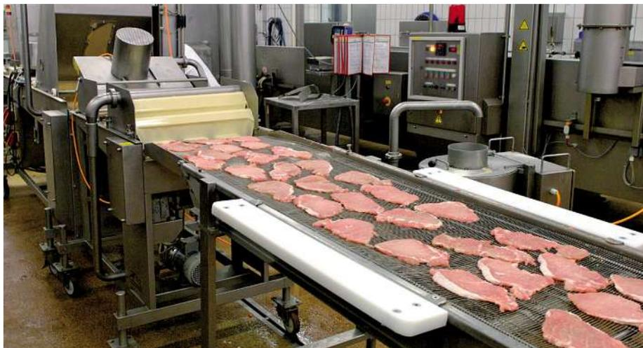
**Bild 1:** Fördertechnik mit Gurten, Modulbändern, Drahtgeflechtbändern oder Scharnierplattenbändern kann mehr leisten als den reinen Warentransport: In der Lebensmittelbranche werden damit auch Aufgaben wie das Wenden und Drehen von Fleischstücken erledigt.
