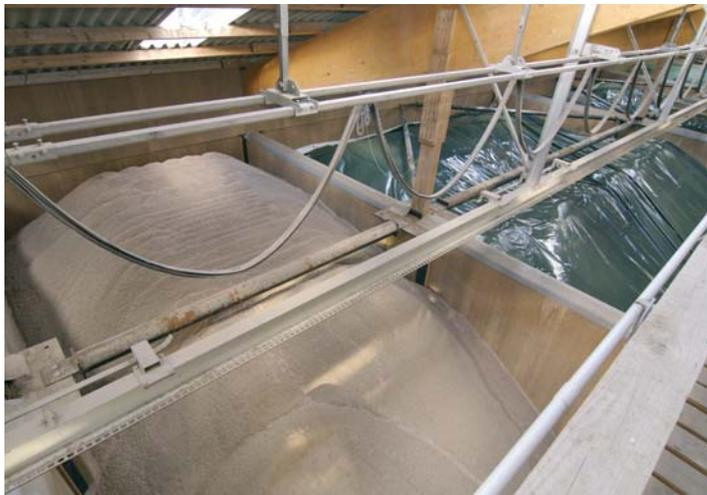
Abb. 3: Die Befüllung der Boxen ist deutlich gleichmäßiger als bei punktueller Befüllung. Aus der sonst üblichen „Bergspitze“ wurde ein „Hochplateau“.
