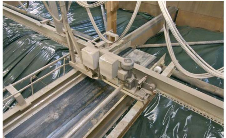
Abb. 4: Deutlich erkennbar ist das Zahnrad am Motor, das in die Lochschiene greift. Damit ist jederzeit die Position exakt bestimmbar. Bei gummierten Rollen ist eine aufwendige Steuerung oder eine Steuerung nach Sicht erforderlich.
