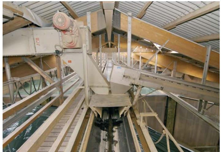
Abb. 5: Zuführende Fördertechnik und Hauptverteiband
