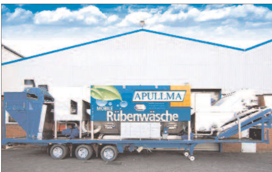
Die Firma Apullma hat die erste mobile Rübenwaschanlage gebaut, die Zuckerrüben zuverlässig und direkt auf dem Feld von Verschmutzungen und anhaftenden Steinen befreit und die Rüben so zu einem Biogassubstrat der Zukunft macht. Fotos: Apullma
