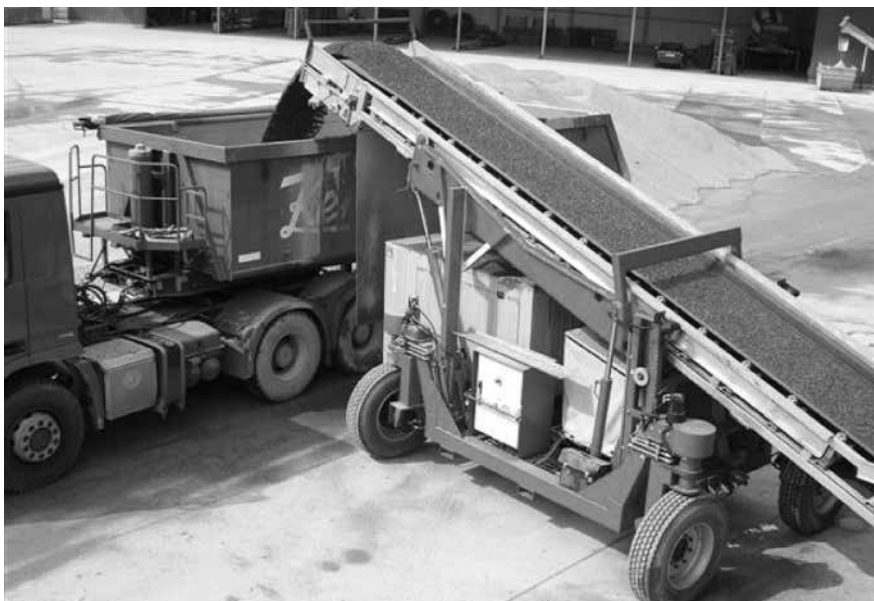
Bild: Dank der um 140° verstellbaren Räder kann der Förderbandwagen parallel zur Längsseite des Zuges verfahren werden
