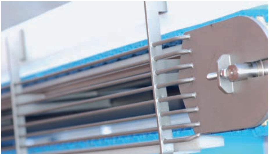
Abb. 4: Seitliche Rundstäbe dienen als Schutzvorrichtung und erhöhen die Arbeitssicherheit, ohne dabei die Hygieneigenschaften einzuschränken.
