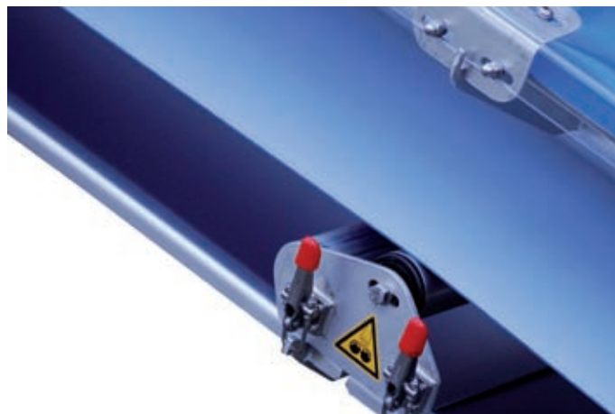
Abb. 2: Auffangwannen sorgen dafür, dass Feinstpartikel, die beim Rücklauf des Gurtes noch mitgeführt werden, nicht zu Boden fallen.
