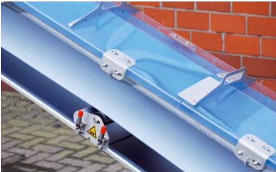
Die zur Reinigung leicht abnehmbaren Polycarbonat-Schutzhauben schützen das Fördergut vor Fremdkörpern
