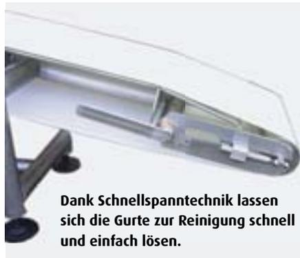
**Dank Schnellspanntechnik lassen sich die Gurte zur Reinigung schnell und einfach lösen.**
